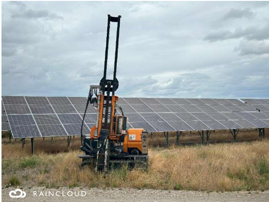
Plate 12-23 Mini pile driver examples
